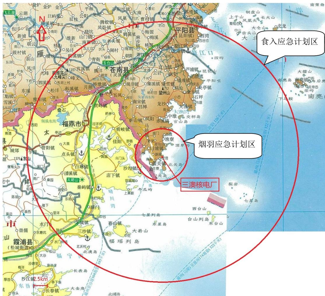
图 7.5-2 三澳核电站食入应急计划区示意图
